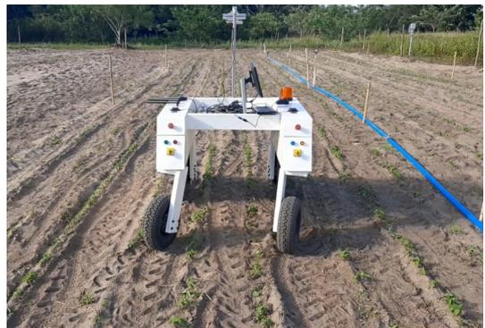
Figura 1. Robô Soybot percorrendo o interior de uma plantação de soja em um estágio inicial de crescimento.
